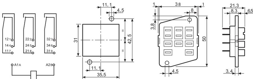
Bauhöhe mit Relais 62.33 oberhalb der Montageplatte ist 63,3 mm
