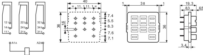
Bauhöhe mit Relais 62.33 oberhalb der Leiterplatte ist 63,3 mm
